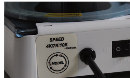
Référence / Code 52507015 Bouton sélecteur de vitesse sur la partie arrière Speed button, back of the equipment
