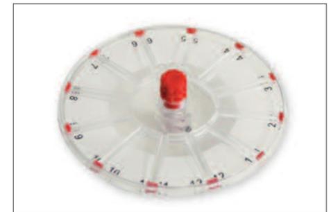
[4] Rotor à bandes pour micro-tubes de 0.2 mL
